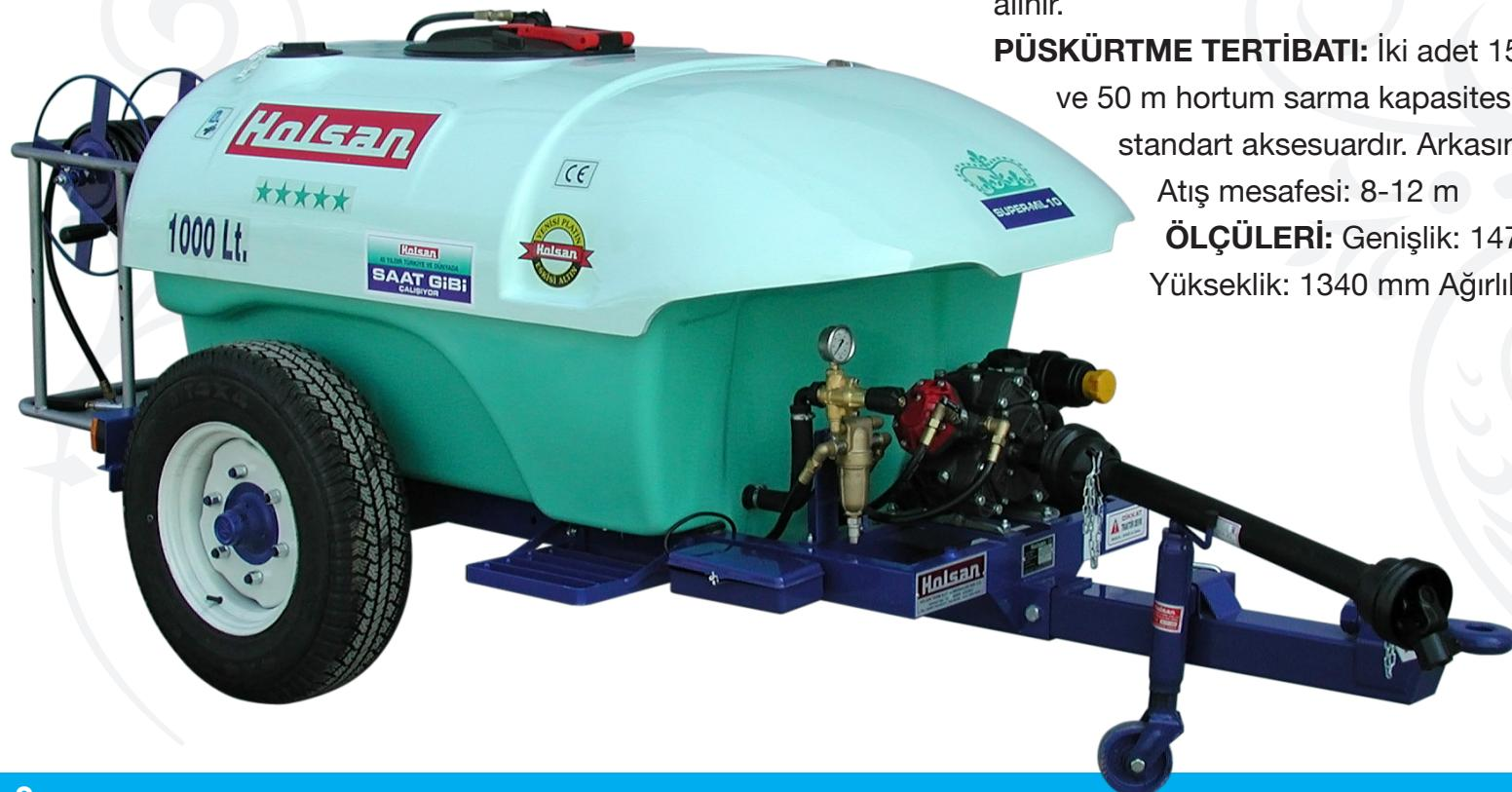
**DEPO:** 1000 litre kapasiteli, içinde hidrolik karıştırma tertibatı, depo üzerinde kilitlenebilir depo kapağı, nybolttan üretilmiş süzgeci, seviye göstergesi ve boşaltma musluğu mevcuttur.
