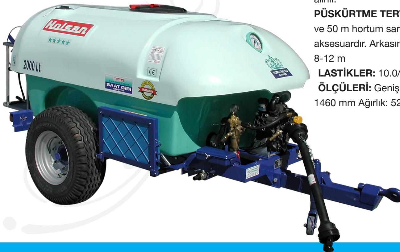
**DEPO:** 2000 litre kapasiteli, içinde hidrolik karıştırma tertibatı, depo üzerinde kilitlenebilir depo kapağı, nybolttan üretilmiş süzgeci, seviye göstergesi ve boşaltma musluğu mevcuttur.
